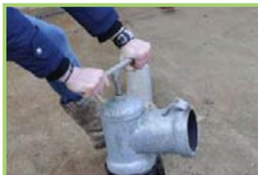
Ne jamais resserrer la vis en laiton sur un réseau sous pression.
