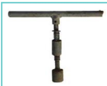
**Les anciennes générations de branchement VBZ** ont une commande qui peut être très **dangereuse** en cas de rupture du boulon.
