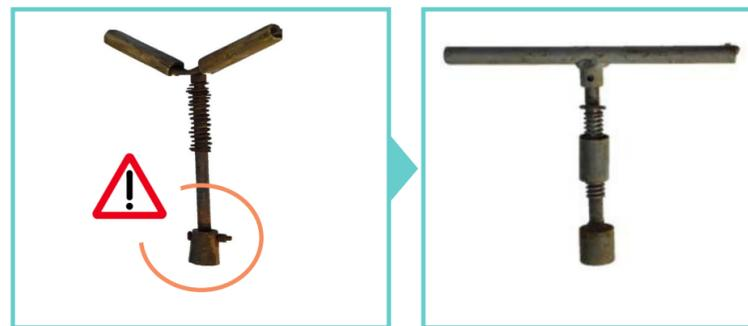
Les anciennes générations de branchement VBZ ont une commande qui peut être très **dangerouse** en cas de rupture du boulon.
