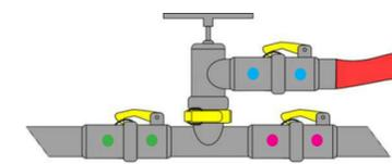
Afin d'éviter que des contraintes mécaniques n'engendrent de rupture, **vérifiez l'enclenchement et l'alignement des différents composants** : Té vanne, branchement VBZ, bouchons, tuyaux, gorges, etc.
