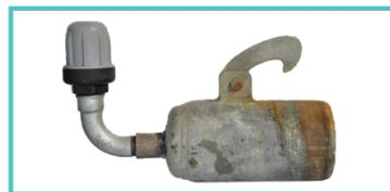
Mécanisme de purge / soupape / évent
